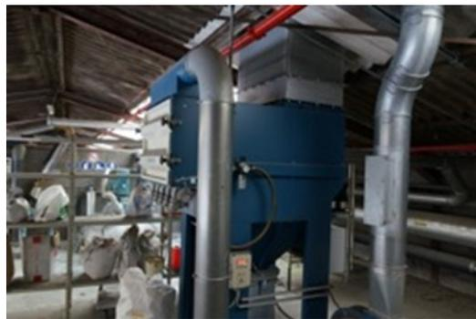
Figure 34 : Atelier Formulation ATEX – Equipement pour le chargement des poudres
